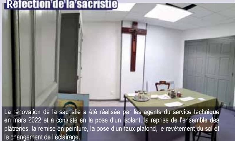
La rénovation de la sacristie a été réalisée par les agents du service technique en mars 2022 et a consisté en la pose d'un isolant, la reprise de l'ensemble des plâtreries, la remise en peinture, la pose d'un faux-plafond, le revêtement du sol et le changement de l'éclairage.
